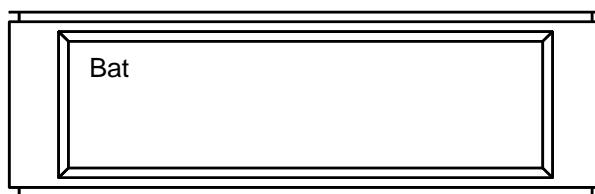
e viene emesso un suono di allarme temporaneo all'accensione dell'unità. Quando la batteria è completamente scarica, il messaggio sopra riportato viene visualizzato in modo continuato ed è necessario sostituire la batteria.
