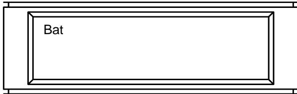
und der Alarm ertönt, sobald das Gerät das erste Mal eingeschaltet wird. Wenn die Batterie vollständig entladen ist, wird die obige Meldung dauerhaft angezeigt und die Batterie muss gewechselt werden.
